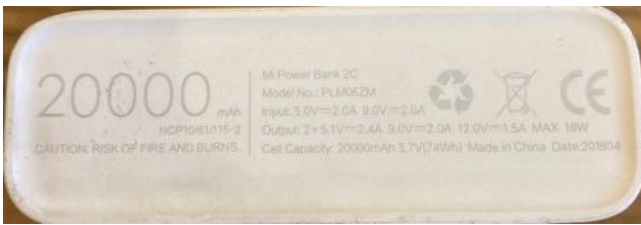
Рисунок 2 PowerBank MI Bank 2C шильдик производителя (толщина 2 см, ширина 8 см)
