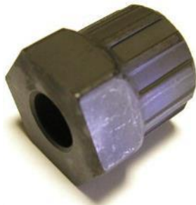
Съемник кассеты для дисков CenterLock
