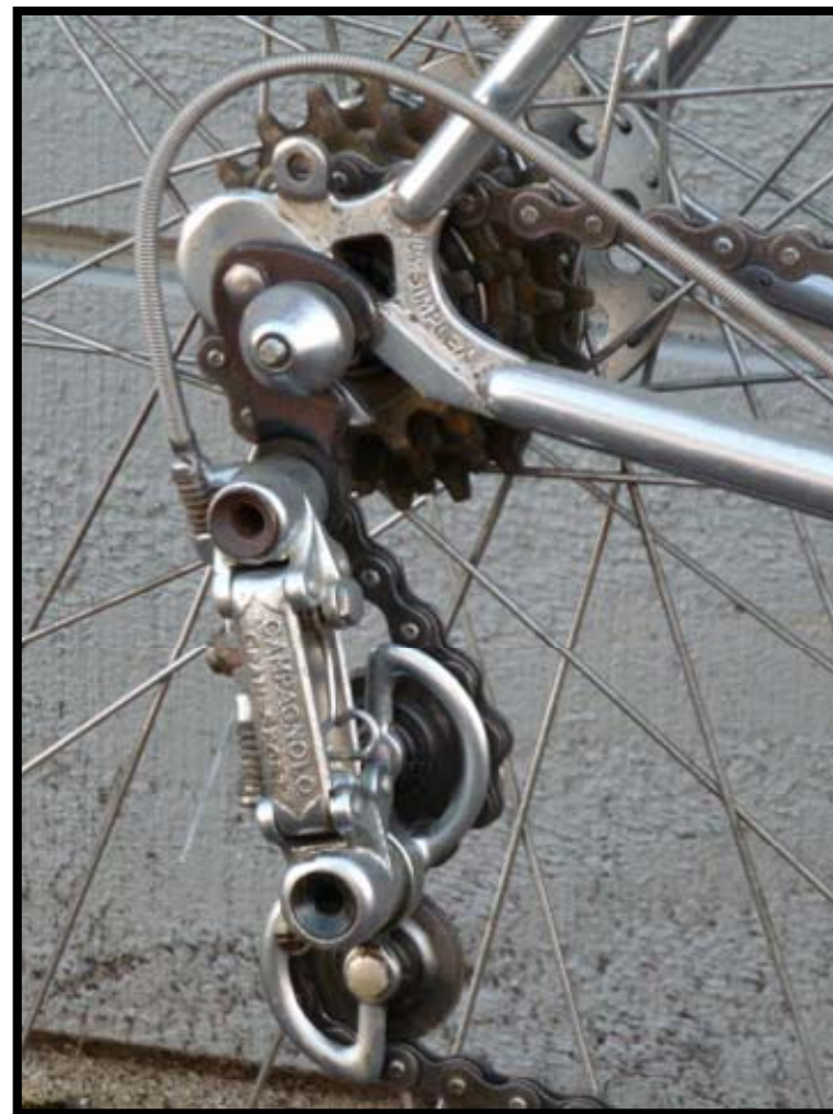
Переключатель скоростей современного типа, Туллио Кампаньоло, 1951 г.
